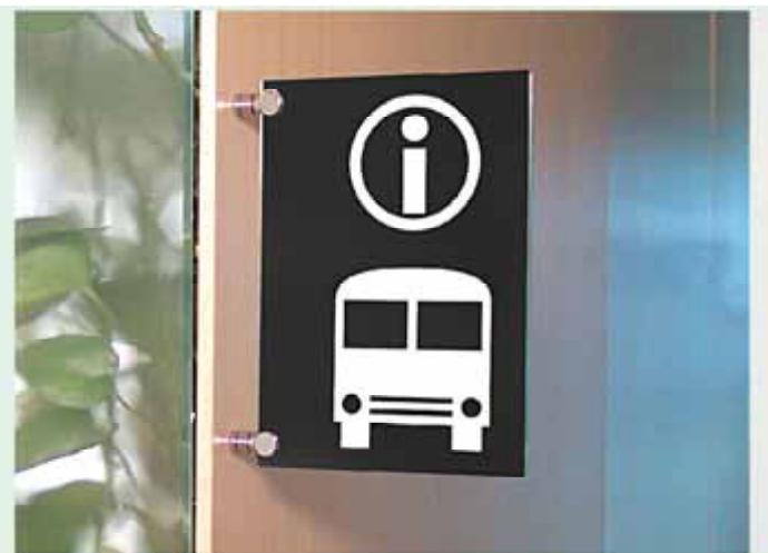
**■ morsetto variabile a bandiera per parete o soffitto.** per montaggi di pannelli a bandiera o direttamente a soffitto, morsetto flessibile per pannelli con diversi spessori, il fissaggio del pannello avviene tramite le brugole. **fissaggio:** morsetto variabile a bandiera con sistema a brugola. **materiali:** ottone cromato argento satinato o cromo lucido. **sospensione del pannello:** max 10mm. **distanza dalla parete:** 15mm. **furo del pannello:** Ø>4mm.
