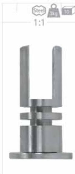
**II morsetto a bandiera in acciaio per parete o soffitto.** per montaggi di pannelli a bandiera o direttamente a soffitto, il fissaggio del pannello avviene tramite le brugole, anelli di protezione inclusi. **fissaggio:** morsetto a bandiera con sistema a brugola. **materiali:** acciaio inox AISI303. **spessore del pannello:** max. 8mm o 11mm senza anelli. **distanza dalla parete:** 25mm.
