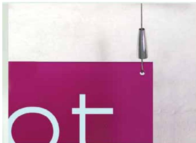
**1 fermacavo.** Far passare il cavo di acciaio o di nylon all'interno del fermacavo e bloccarlo con la brugola. **fissaggio:** fermacavo per cavi in acciaio; sistema a brugola. **materiali:** ottone color argento satinato. **spessore del cavo:** max. Ø2mm.
