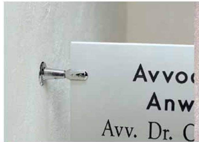
**■ morsetto a bandiera per parete o soffitto.** per montaggi di pannelli a bandiera o direttamente a soffitto, il fissaggio del pannello avviene tramite le brugole. **fissaggio:** morsetto a bandiera con sistema a brugola. **materiali:** ottone con cromatura in color oro lucido, argento satinato o cromo lucido. **sospensione del pannello:** max 8mm. **distanza dalla parete:** 38mm.
