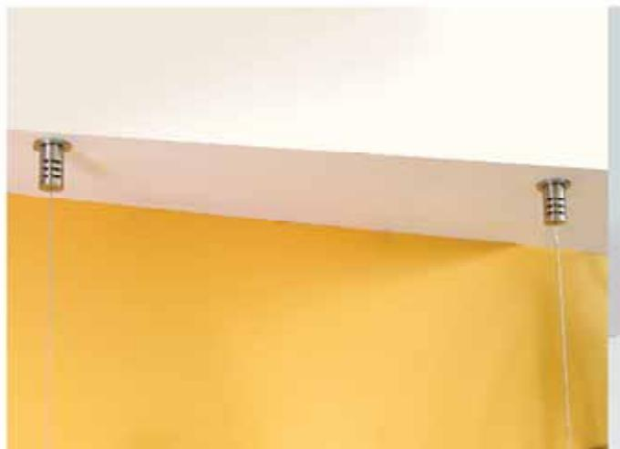
**tirante in acciaio per cavi con sistema a brugola.** fissaggio a soffitto universale, in acciaio inox, per cavi di acciaio o di nylon o per catene, montare il tirante a soffitto, inserire il cavo nel morsetto e fissarlo con le brugole. **fissaggio:** tirante per cavi, sistema a brugola. **materiale:** acciaio AISI303, testina con sfaccettature. **distanza dal soffitto:** 35mm. **spessore del cavo:** max. Ø2mm.
