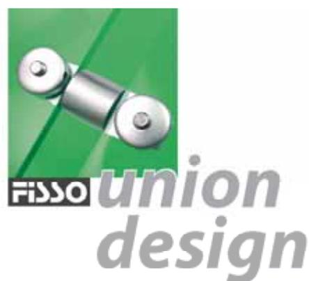
**connettore bifacciale per pannelli, sistema autobloccante.** morsetto in ottone lavorato per la connessione verticale di due pannelli. connettore flessibile per pannelli con diversi spessori. il fissaggio avviene tramite le brugole.
