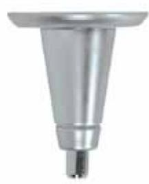
**tirante per cavi con sistema autobloccante.** fissaggio a soffitto per cavi di acciaio o di nylon. montare il tirante a soffitto e inserire il cavo nel morsetto. il meccanismo di autobloccaggio trattiene automaticamente il cavo. **fissaggio:** tirante per cavi, sistema autobloccante. **materiali:** ottone color oro o cromo lucido e argento satinato. **distanza dal soffitto:** 35mm. **spessore cavo:** max. Ø2mm.
