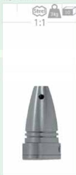
**II morsetto variabile a bandiera in acciaio per parete o soffitto.** per montaggi di pannelli a bandiera o direttamente a soffitto, il fissaggio del pannello avviene tramite le brugole. **fissaggio:** morsetto variabile a bandiera con sistema a brugola. **materiali:** acciaio inox AISI303. **spessore del pannello:** max. 10mm, spessori maggiori con burgoie più lunghe. **distanza dalla parete:** 13mm.
