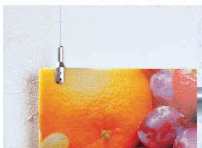
**DE morsetto variabile in acciaio per pannelli con cavi.** morsetto per cavi di acciaio o di nylon o per catene, il fissaggio del pannello e del cavo avviene tramite le brugole. **fissaggio:** morsetto per pannelli, sistema a brugola. **materiale:** ottone con cromatura in color oro lucido, argento satinato o cromo lucido. **spessore del pannello:** max. 8mm. **spessore del cavo:** max. Ø2mm.
