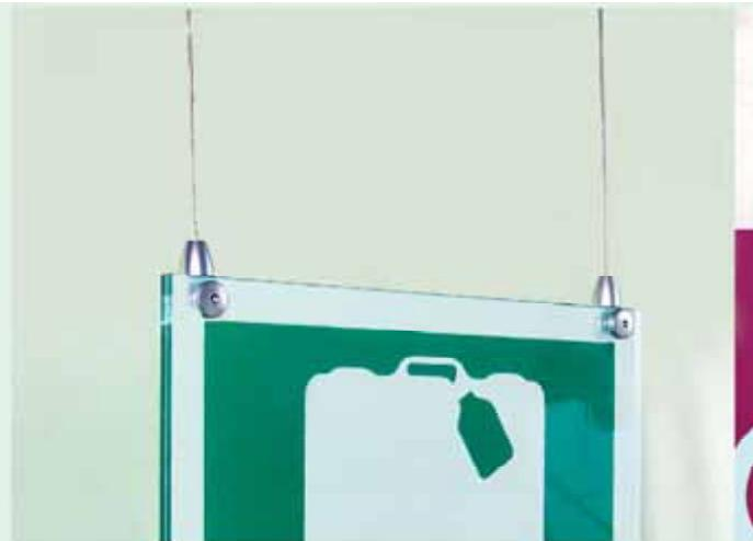
**DE morsetto variabile per pannelli con cavi.** morsetto per cavi di acciaio o di nylon o per catene, il fissaggio del pannello e del cavo avviene tramite le brugole. **fissaggio:** morsetto per pannelli, sistema a brugola. **materiale:** ottone con cromatura in color argento satinato o cromo lucido. **spessore del pannello:** variabile da 0mm a 10mm. **spessore del cavo:** max. Ø2mm.
